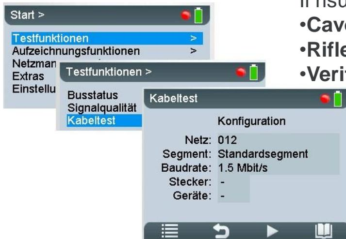
Il cable test va effettuato utilizzando il connettore standard, BC-600-PB-CB-DSUB-2
