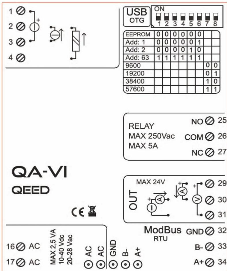
**CONFIGURAZIONE INDIRIZZI MODBUS E BAUDRATE VIA DIP-SWITCH**
